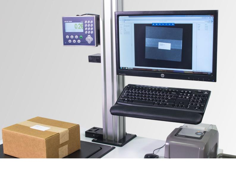
OneSort ermöglicht eine effizientere Paketsortierung mithilfe der Software zur automatisierten Adressblockerkennung (Address Block Locator, ABL).
