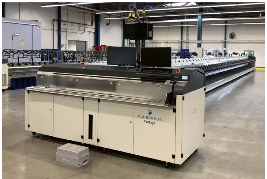
Vantage Sortiersystem mit den neuen Mixed Mail Stackern.
