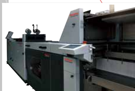
LIGNE SÉRIE 200 COMBINÉE AVEC MARGEUR NUMÉRIQUE HOF 400 ET TOURS I/AC 1000 ET STACKER SEMI-HAUTE PILE ST40
