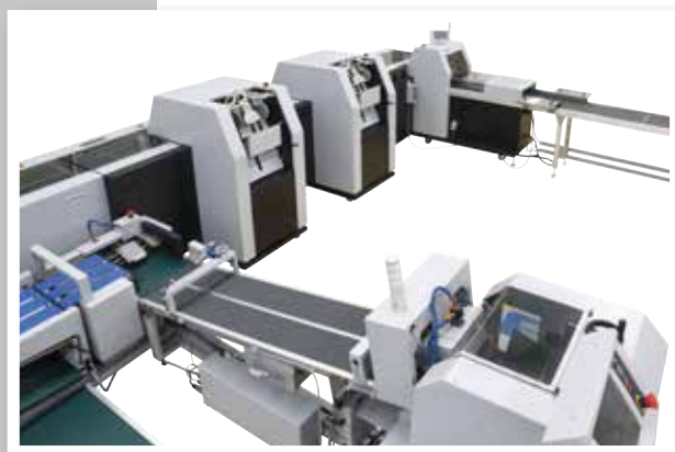
MARGEURS ADDITIONNELS INDÉPENDANTS ASF-SB POUR L'AJOUT DE FEUILLETS, ENCARTS, CAHIERS.
