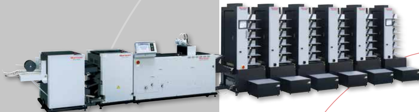
LIGNE DE FINITION SÉRIE 200 AVEC 6 TOURS L I/AC 600 H (36 POSTES) ET COUPE 3 FACES EN SORTIE
