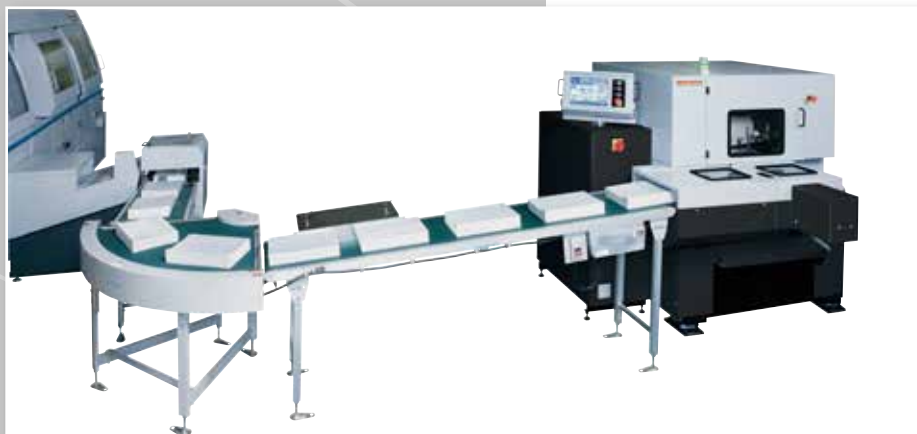
MASSICOT HT 80 (3 LAMES) CONNECTÉ AU RELIEUR BQ 470/480 - UTILISATION EN SOLO POSSIBLE AVEC INTRODUCTION DES OUVRAGES SUR CONVOYEUR D'ENTRÉE
