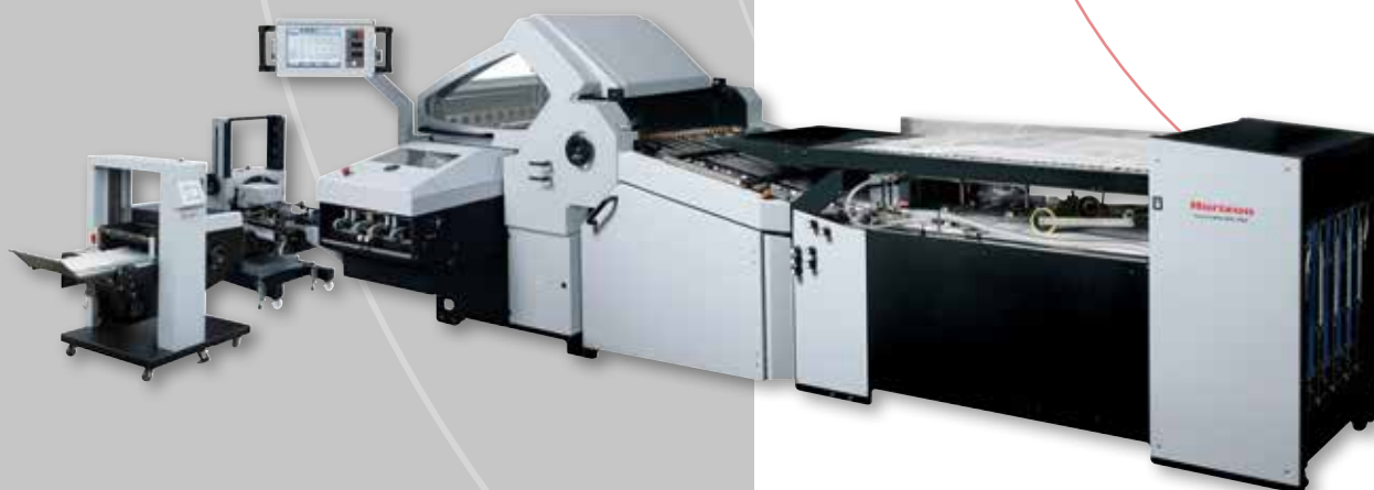
AFC 746 F MARGEUR PILE RONDE PRESSEUR PST 66 ET COUPEAU MOBILE MKU 38
