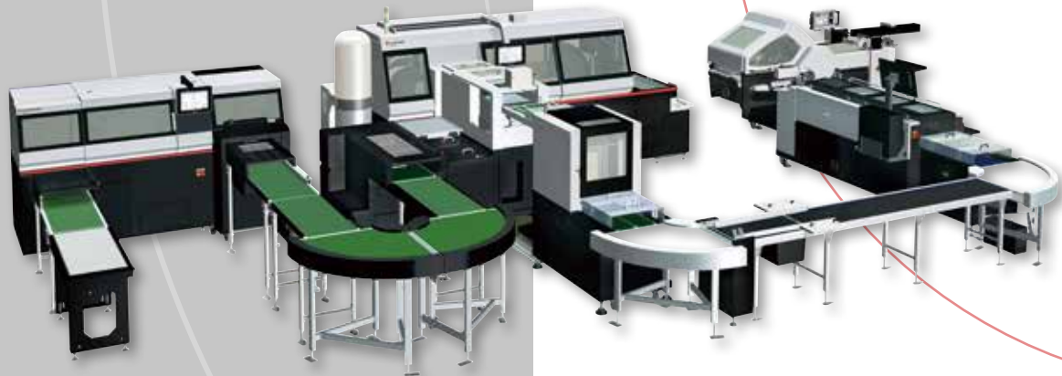
PLIEUSE AFV 56 POCHE/COUTEAU (OU POCHE/POCHES). MODULE BBS 40 DE PRÉ-ENCOLLAGE DES BOOK-BLOCS. INTRODUCTEUR AUTOMATIQUE BBF 480, RELIEUR BQ 500 ET COUPE 3 FACES HT 300
