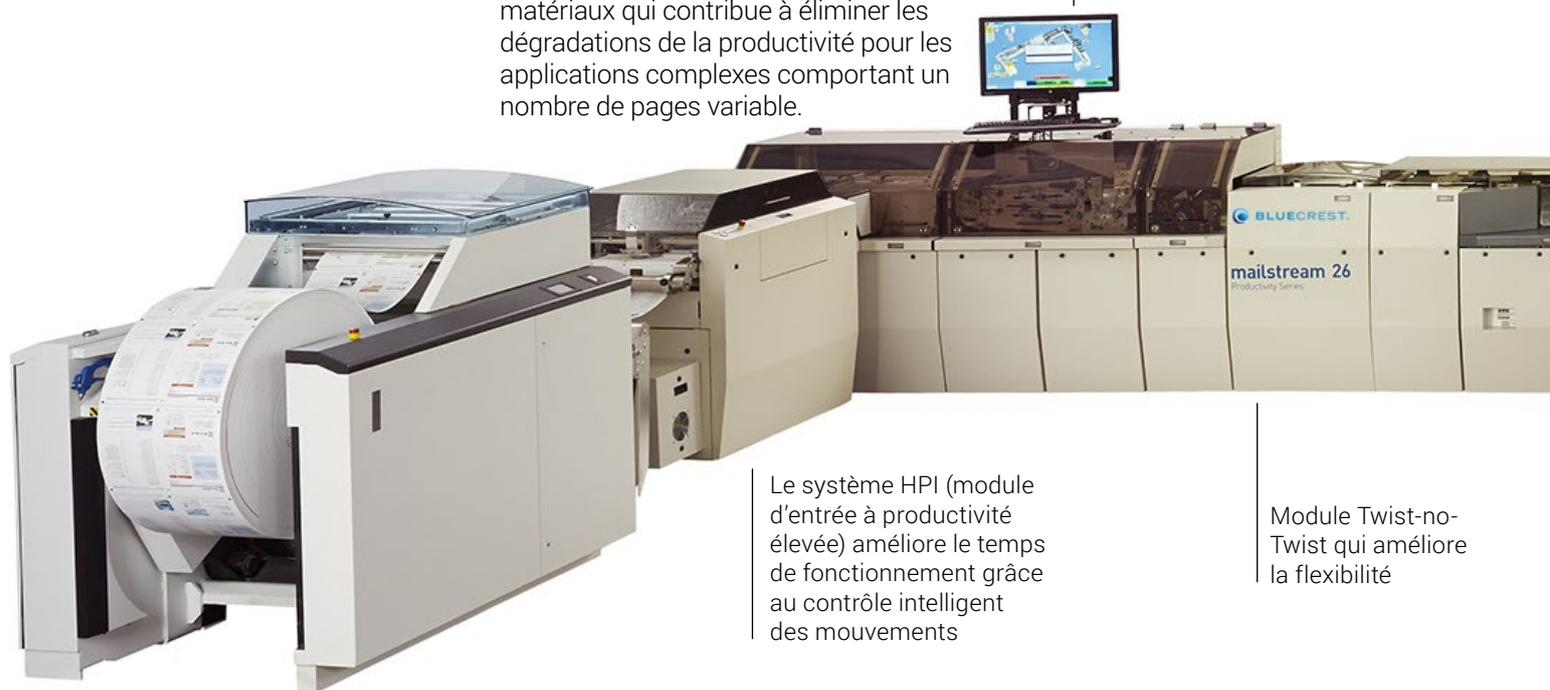
Le système HPI (module d'entrée à productivité élevée) améliore le temps de fonctionnement grâce au contrôle intelligent des mouvements
