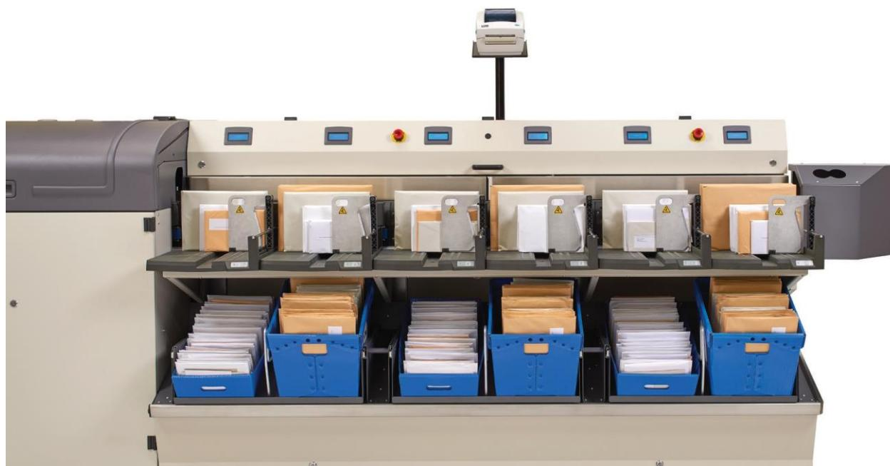
Mixed Mail Stacker (MMS) ソリューションは片面または両面構成を選択することができます。MMS はポケット 6 基単位で増減可能なスタッカーモジュール、制御システム、および最大 10 mm の厚みの郵便物を処理できる区分け搬送機構部で構成されています。MMS は片面スタッカー、またはオプションの両面スタッカーおよび U ターンモジュールで構成されており、既存の実績のある Vantage™ インプットモジュールと組み合わせることでお客様の現在または将来のビジネスニーズに応えます。
