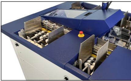
Kontinuierlicher Betrieb: Beschickung der Feeder bei laufendem Betrieb, um Produktionsunterbrechungen zu vermeiden
