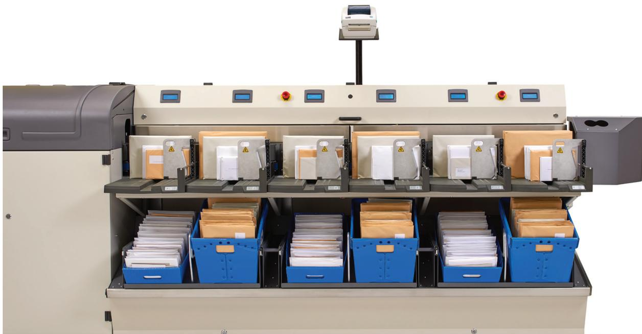
Die Mischpostfächer sind in ein- und zweiseitiger Konfiguration erhältlich. Jede Fachsektion besitzt 6 Fächer mit dazugehörigen Informationsanzeigen, die Poststücke bis zu 10 mm verarbeiten können. Bei der zweiseitigen Konfiguration ist ein Wendemodul integriert.
